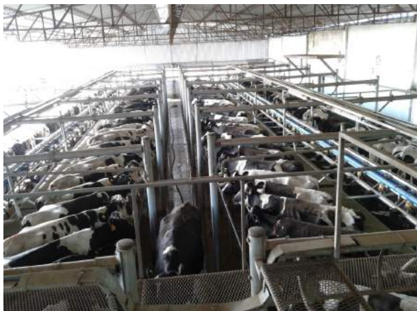
Sala de ordeño de tambo tecnificado en sistema empresarial con brete de caño, espina de pescado con lato rendimiento en cuanto a la cantidad de vacas ordeñadas/hora.
