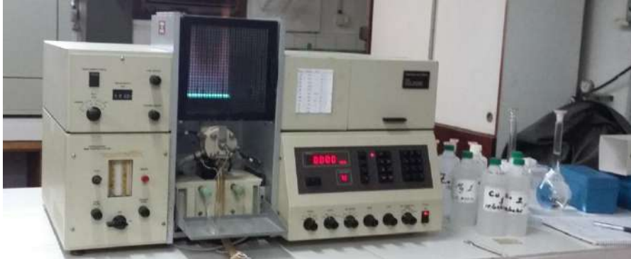
Foto N° 6. Espectrofotómetro de absorción atómica, preparado para la lectura de los minerales.
